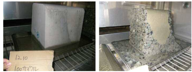
ハレーサルト 普通コンクリート 写真-1 複合劣化試験結果
